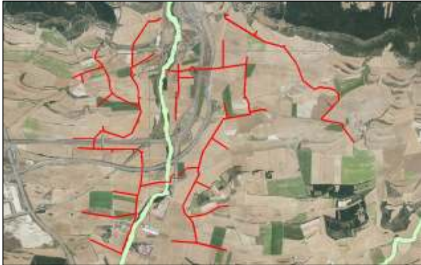
Figura 23.- Red de distribución del regadío (línea roja) y AIE del blenio de río (verde).
