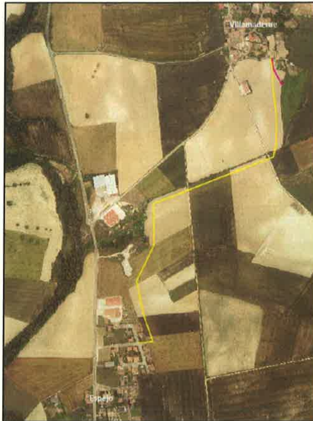
Trazado del Colector propuesto entre Villamaderne y Espejo, en amarillo. En color rosa el nuevo aliviadero.
