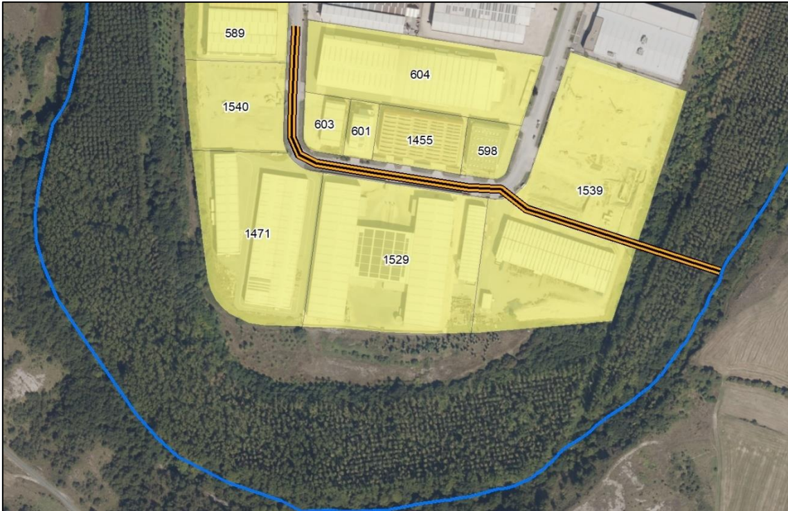
Figura 18.- Trazado del colector y área de desagüe de la alternativa 2 (línea naranja y negra). Los polígonos amarillos representan el parcelario del Polígono Industrial de Goian y la línea azul el río Santa Engracia.
