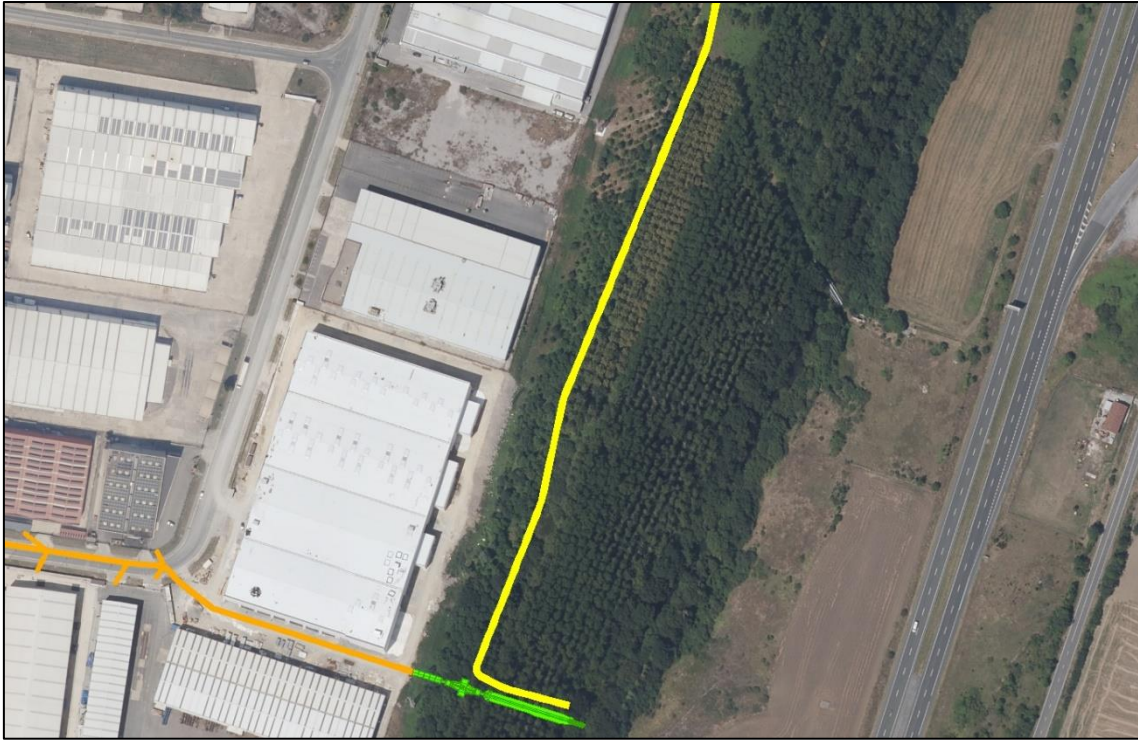
Figura 13.- Detalle del sector sur del vial de acceso al área de desagüe (línea amarilla); en naranja el colector y en verde el canal de desagüe.
