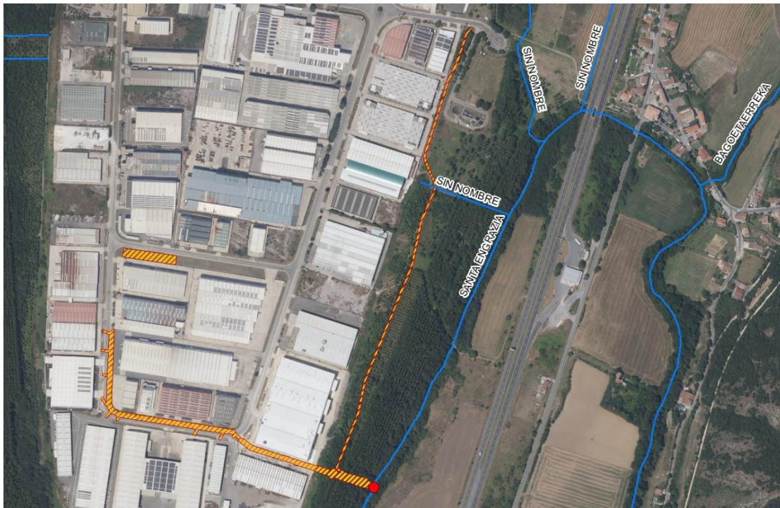
Figura 24.- Superficie de máxima ocupación del proyecto en fase de obras (polígono naranja rayado), red fluvial (línea azul) y punto de desagüe del colector al río Santa Engracia (círculo rojo).
