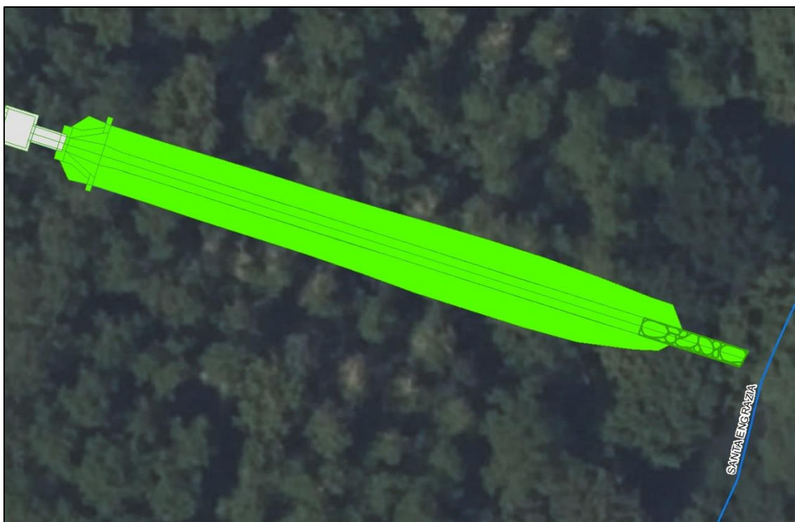
Figura 9.- Canal trapezoidal de vertido final (polígono verde) al río Santa Engracia (línea azul oscuro). Se muestra el tramo final en escollera.
