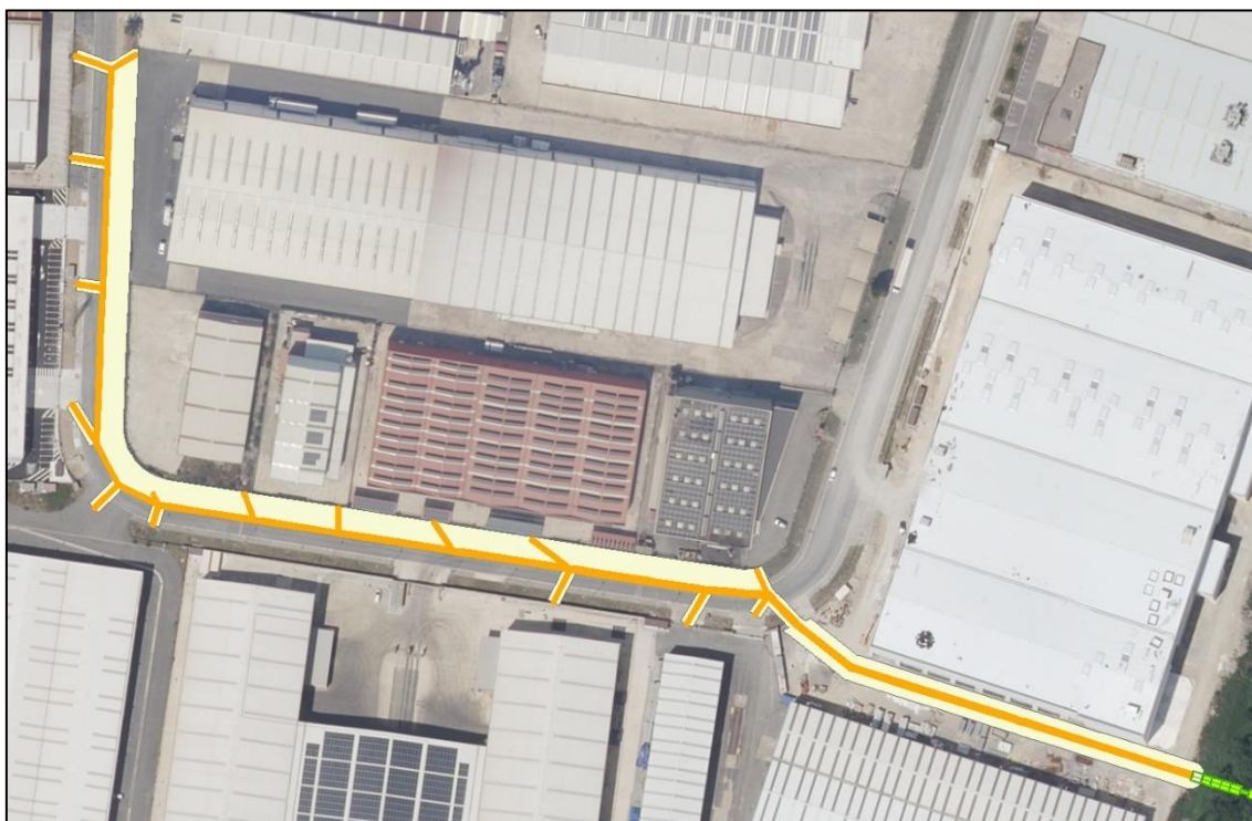
Figura 6.- Área de ocupación del colector (polígono naranja) y área de ocupación temporal en fase de obras destinada a la instalación del colector (polígono amarillo).
