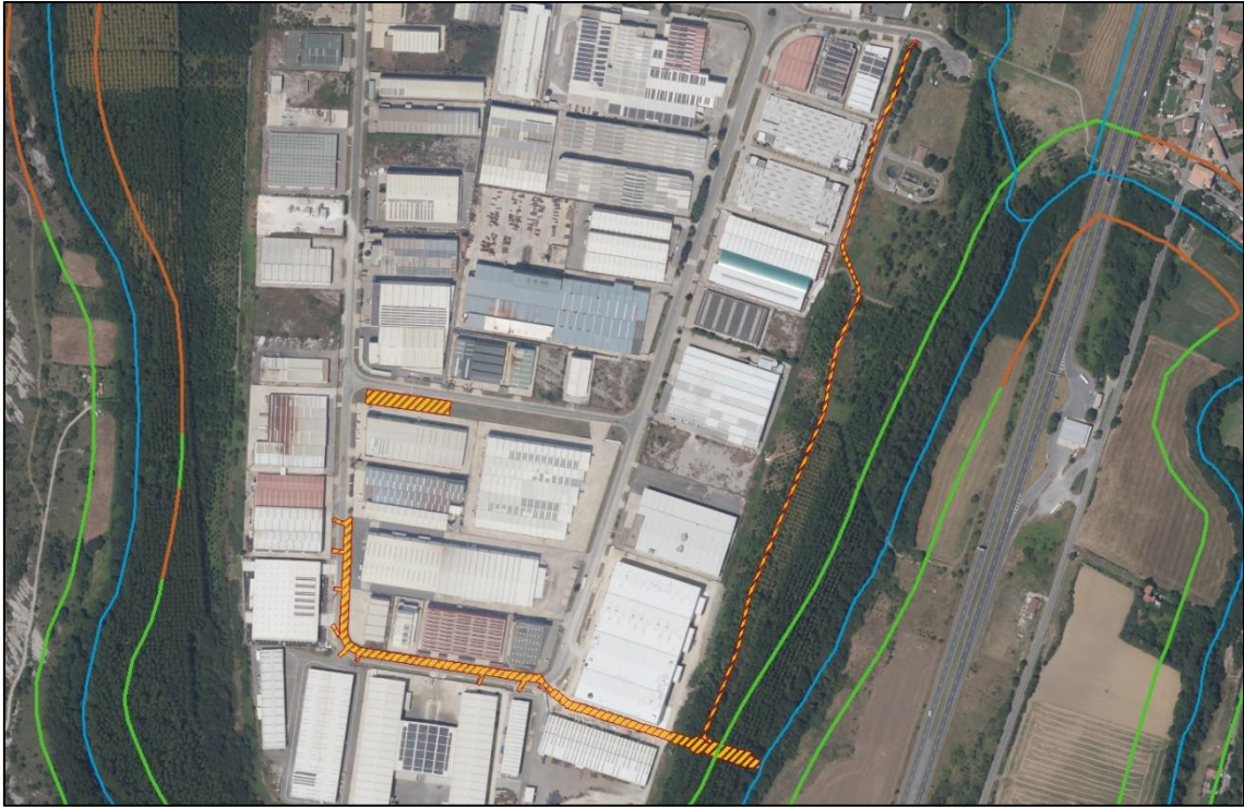
Figura 30.- Superficie de máxima ocupación del proyecto en fase de obras (polígono naranja rayado), río Santa Engracia (línea azul) y componente medio ambiental del PTS de Ríos y Arroyos de la CAPV (línea verde Márgenes con vegetación bien conservada; línea marrón Márgenes con necesidad de recuperación).
