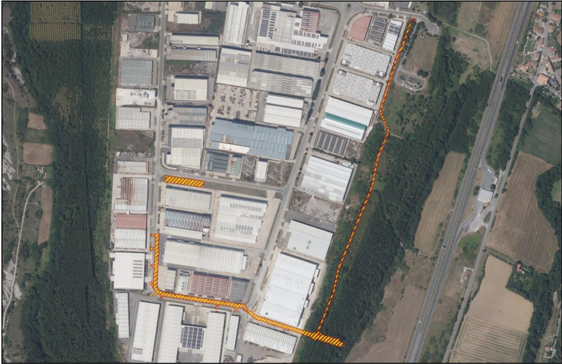
Figura 15.- Área de ocupación máxima en fase de construcción del colector de aguas pluviales en el Polígono Industrial de Goiain (polígono rayado naranja).
