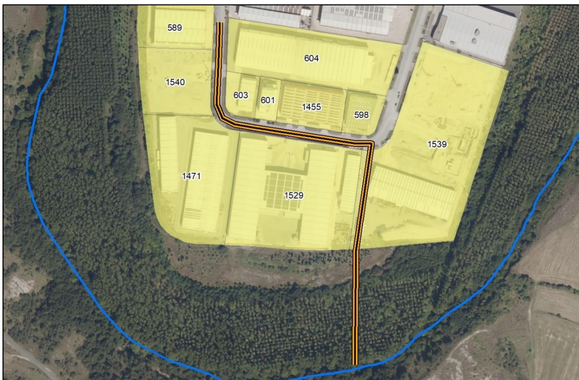
Figura 17.- Trazado del colector y área de desagüe de la alternativa 1 (línea naranja y negra). Los polígonos amarillos representan el parcelario del Polígono Industrial de Goian y la línea azul el río Santa Engracia.
