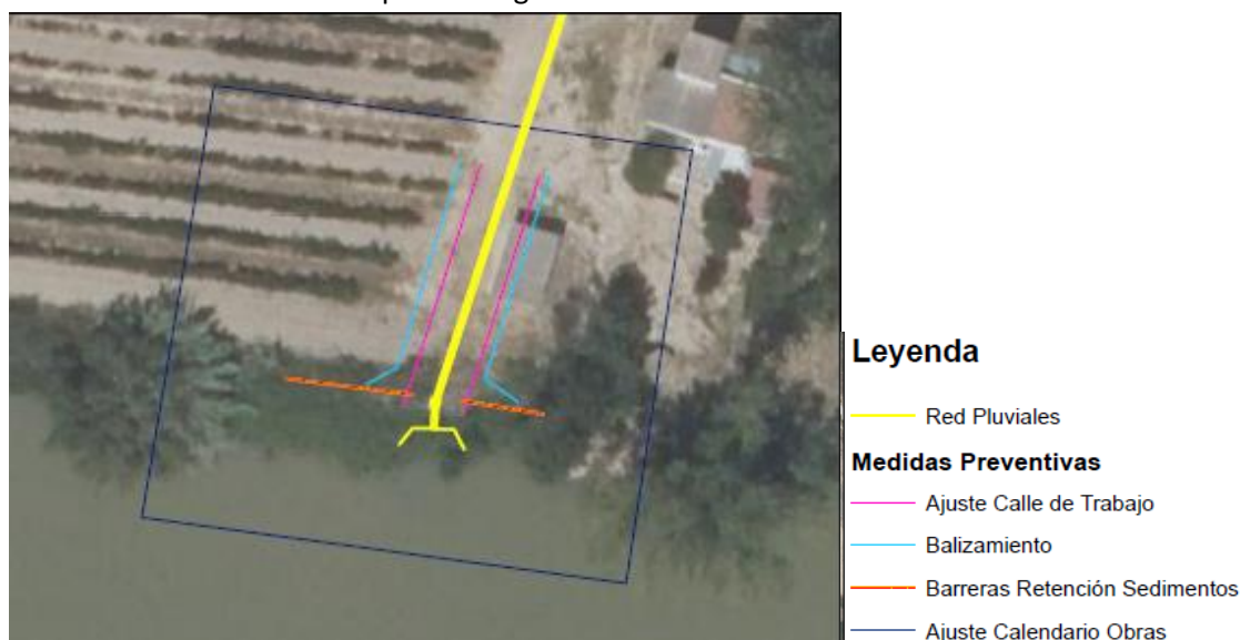
Imagen 20 Detalle zona de llegada al Ebro. En blanco, pasillo donde se ajustará la calle de trabajo a 4-5 m. Línea azul, balizamiento. Línea roja-naranja, instalación de barreras de contención de sedimentos. Fuente: Elaboración propia
