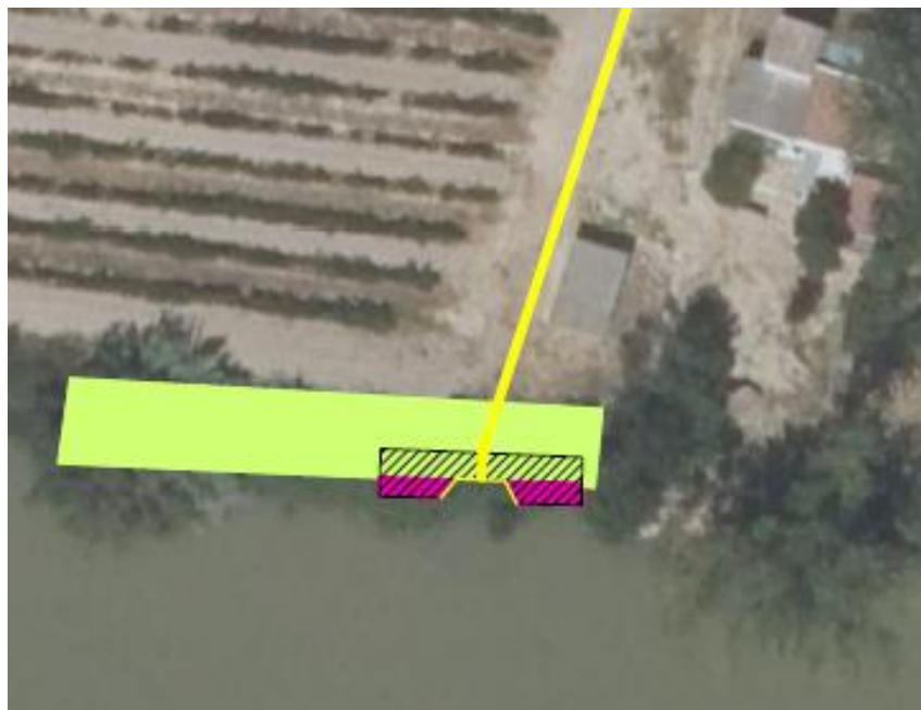
Imagen 21 Rayado negro, colocación de manta orgánica de protección; en verde, zona de restauración de saucedal-alameda; en rosa, estaquillado de sauce. Fuente: Elaboración propia.
