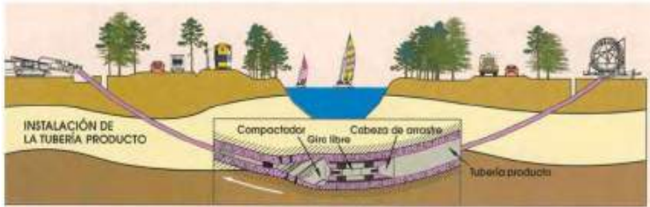
Figura 2.11.5.3.3.- Esquema instalación de la tubería (Fuente: Ibersun)
