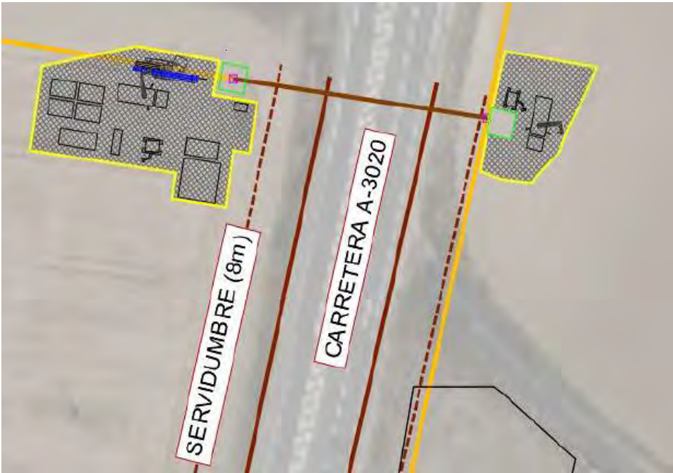
Figura 2.3.3.3.3.- Situación con carretera A-3020 (Perforación Horizontal dirigida) (Fuente: Ibersun)
