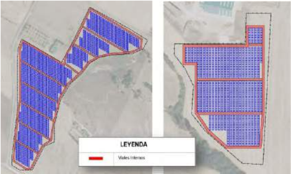
Figura 2.11.3.1.1.- Movimiento de tierras Viales Interiores. (Fuente: Ibersun)
