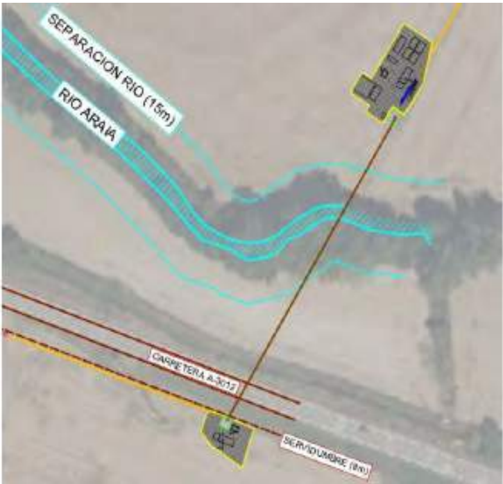
Figura 5.3.1.3.2.- Esquema de cruzamiento del río Araia mediante perforación horizontal dirigida (Fuente: Ibersun)
