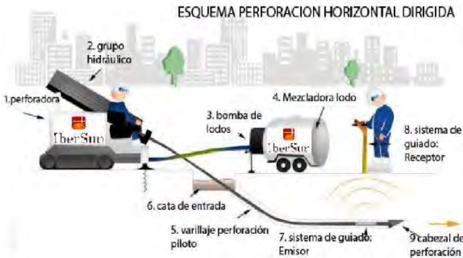
Figura 2.11.5.3.4.- Esquema Perforación Horizontal Dirigida (Fuente: Ibersun)
