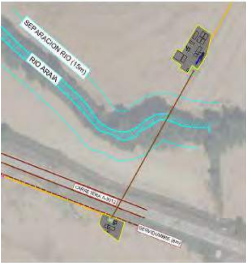
Figura 2.3.3.3.2.- Situación con carretera A-3012 (Perforación Horizontal dirigida) (Fuente: Ibersun)
