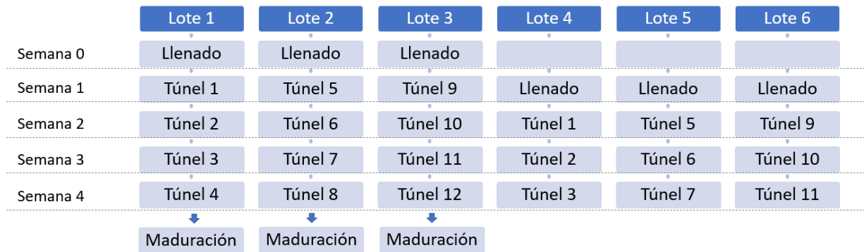
Figura 2. Secuencia de lotes y distribución en la segunda fase (23.000 t/año).
